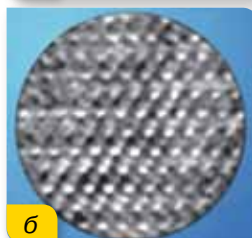
Мал. 83. Електронний мікроскоп (а); фотографія атомів Літію (б)
