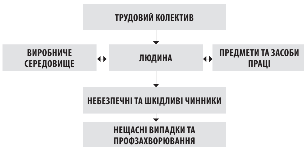
Рис.6.1.Схема взаємодії людини з елементами виробничого середовища
